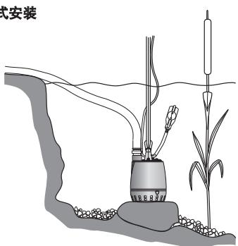
为避免泵过早的损坏，当在死水或江河中使用时，应将泵安置于高出底部一些的地方，以避免细沙被吸入。
